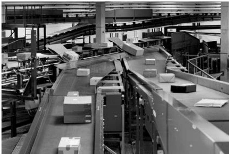
Abbildung 15: Automatische Sortierung in einer Paketsortierhalle von DHL im Jahre 2011. Quelle: Pressefoto DHL.
