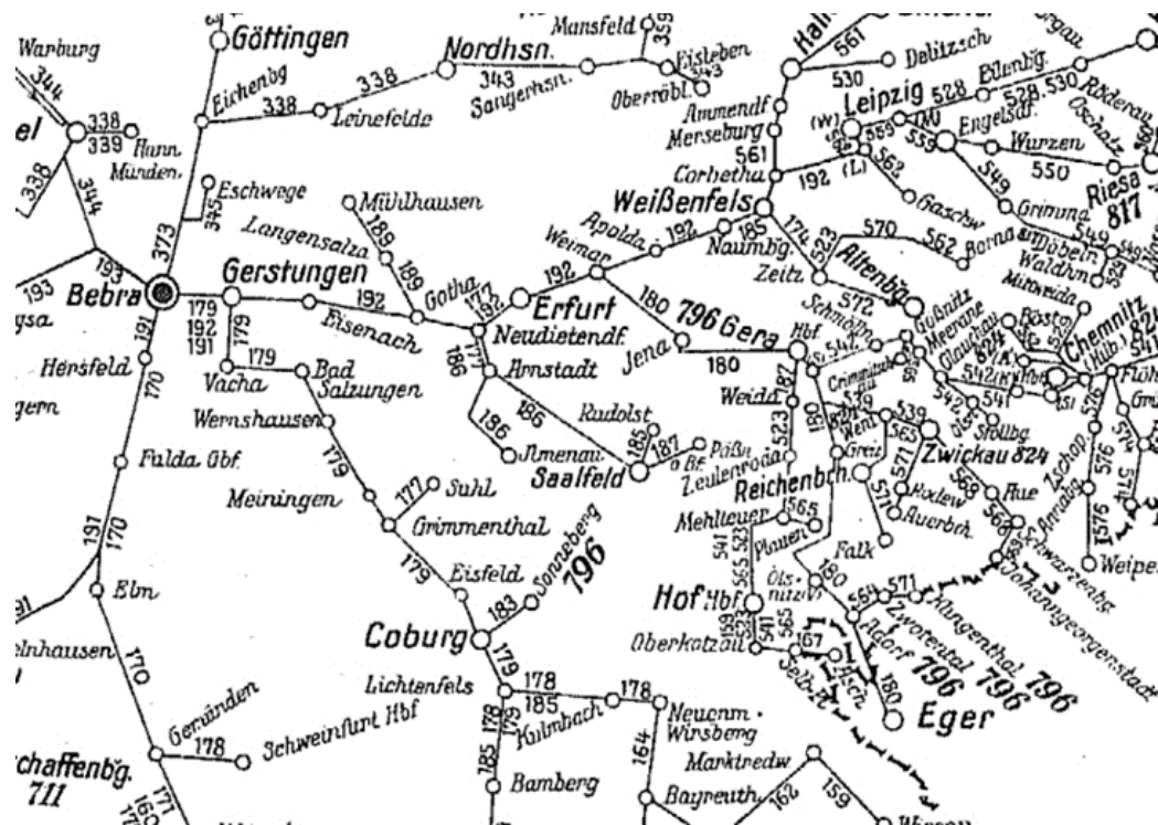
Abbildung 6: Der Baum der kürzesten Wege vom Knoten Bebra aus im Eisenbahnnetz des Deutschen Reiches im Güterkursbuch 1930.
